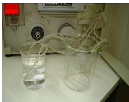
Coloque as mangueiras A/B/CLEANER em um recipiente com água destilada e a mangueira de resíduos em outro recipiente.
