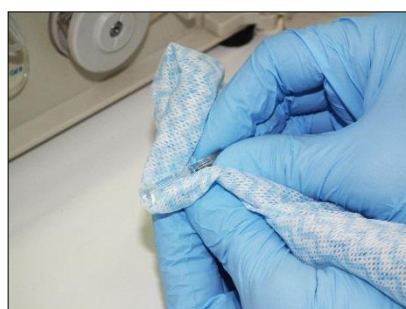
Limpar a trava dos eletrodos com álcool etílico 70%
