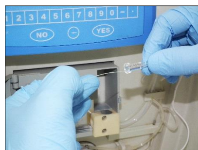
Introduzir um fio dental super floss para eliminar qualquer obstrução no furo
