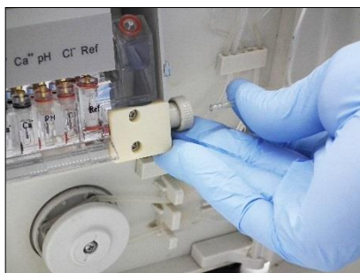
Desconectar a mangueira da trava dos eletrodos
