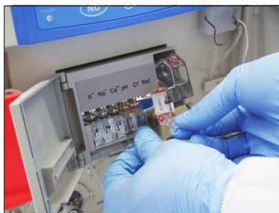
Retirar os eletrodos Referência, K, Na, Cl, Ca e pH
