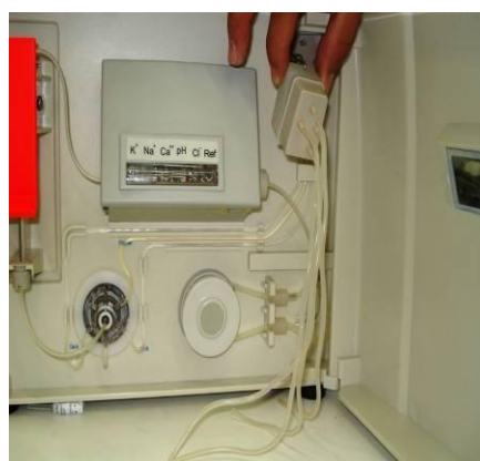
Insira o conjunto de condutos no conector do pack
