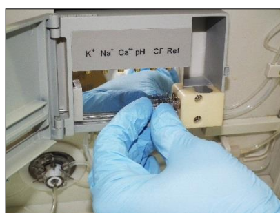
Retirar a trava dos eletrodos
