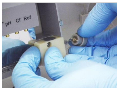
Desrosquear a trava da câmara de eletrodos
